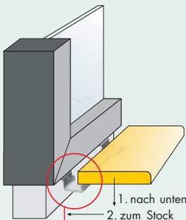
**Rosetten** (3 Stk. pro Laufmeter): Dienen zur Verankerung der Fensterbank im Mörtelbett. Rosetten mit den beiliegenden Schrauben in die Fensterbankrückseite einschrauben.
