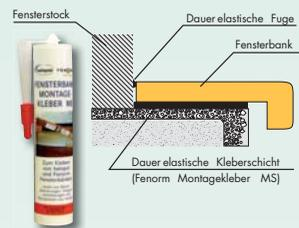
Die HIRTH-Innenfensterbank wird mittels dauerelastischem Kleber (Montagekleber MS) auf das vorbereitete Mauerwerk geklebt. Der Kleber sollte punktuell im Abstand von ca. 15 cm **satt** auf das Mauerwerk aufgetragen werden. Den Kleber raupenförmig, quer zum Mauerwerk im Abstand von ca. 15 cm auftragen. Raupenhöhe mindestens 10 mm.
